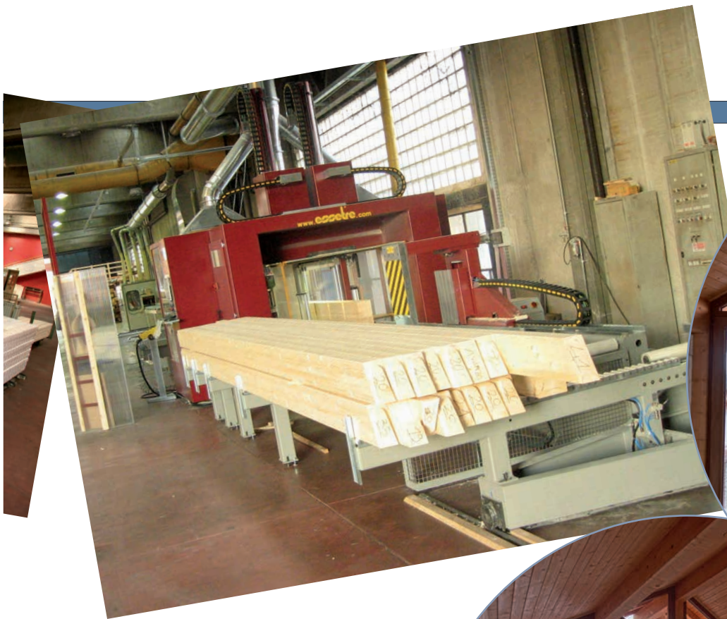
Sopra: la linea Essetre per la lavorazione delle travi lamellari.
